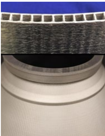
➤ Na przekroju poprzecznym dyszy widać, że nie jest ona litym dzwonem. Tymi kanalikami pompowana jest część wodoru, bardzo skutecznie chłodzącego dyszę wylotową, co chroni jej integralność.
