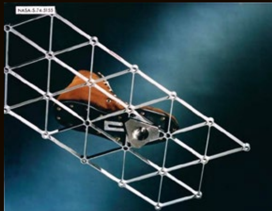
■ Schemat mechanicznego przytwierdzenia buta Skylab do trójkątnej kratownicy stacji. Wdepnąć łatwo, uwolnić się już nie.
