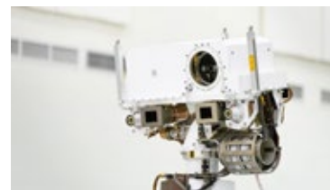
✦ „Głowa” łazika jest naszpikowana kamerami. Tulejki po obu stronach to Navcamy, dwa kwadraty to Mastcamy-Z, a duże kółko to SuperCam.
