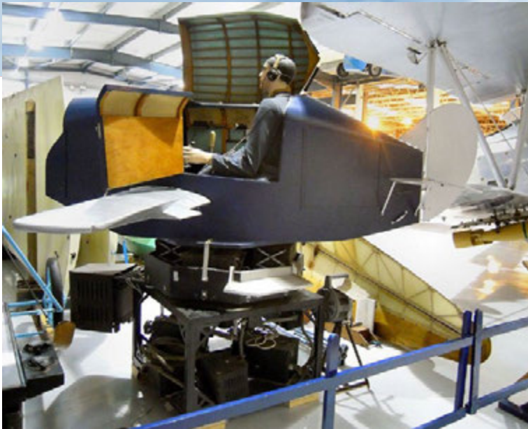
✚ Link Trainer uczył lotów bez widoczności, wyłącznie z wykorzystaniem przyrządów.
