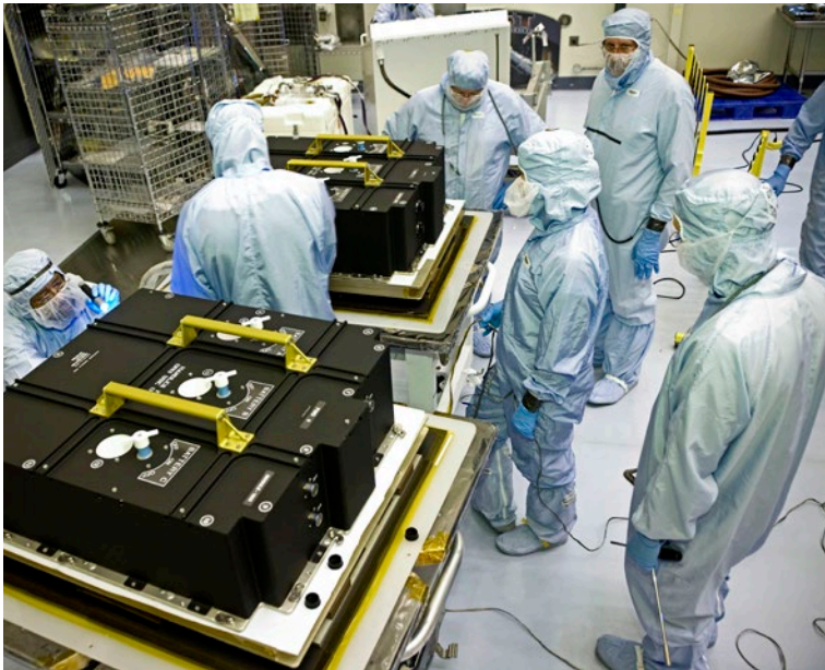
✚ Takich rozmiarów baterie przez 19 lat zasilają kosmiczny teleskop Hubble'a.
