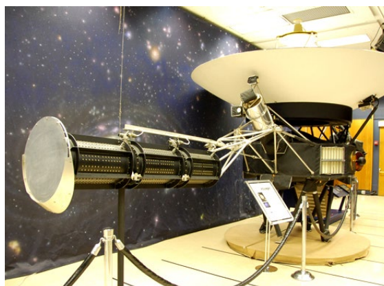
■ Model sondy Voyager. Czarne cylindry po lewej to radioizotopowe generatory elektryczne. Zasilają ją od czterdziestu lat.
