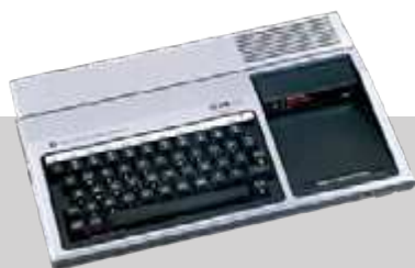
Pierwotna wersja systemu (TI-99/4) była wyposażona w „ultratanią klawiaturę” z klawiszami w stylu kalkulatora. Dopiero TI-99/4A udostępniał lepsze rozwiązanie.
