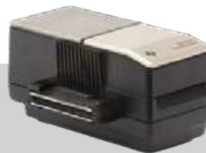
Syntezytor mowy dostępny jako dodatkowy moduł był wykorzystywany przez wiele gier. Planowano nawet produkowanie małych kartridży rozszerzających jego funkcje o nowe słownictwo.
