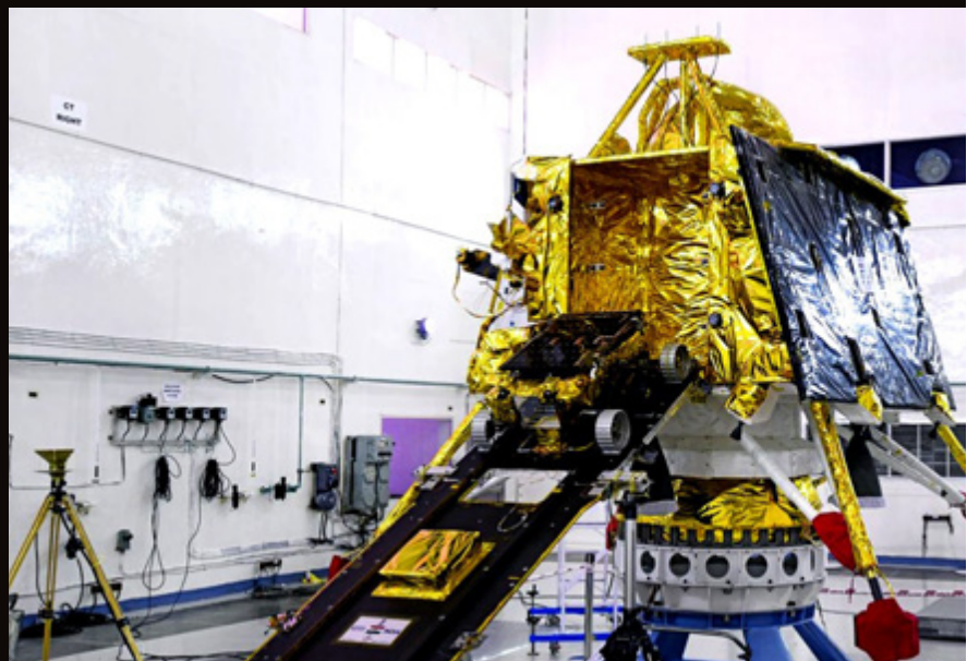
✚ Lądownik Vikram oraz łazik Pragyan razem ważą 1,5 tony, z czego sam łazik tylko 27 kg. Pragyan jest zasilany z ogniw słonecznych i miał na Księżycu pokonać odległość pół kilometra.
