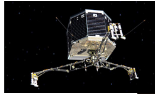
■ Lądownik Philae był wielkości pralki i ważył 98 kilogramów. Podstawowe baterie zapewniały 60 godzin pracy. Dodatkowe baterie, ładowane ogniwami słonecznymi, nie zadziałały, gdyż Philae spoczął w cieniu.
