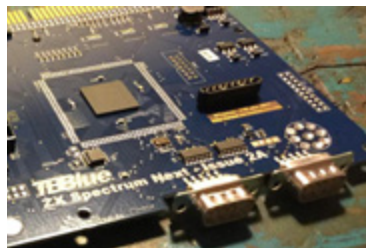
Nowoczesny port rozszerzeń na płycie umożliwia podłączenie PiZero i stworzenie prawdziwego monstrum z procesorem 1 GHz i ponad 512 MB RAM.
